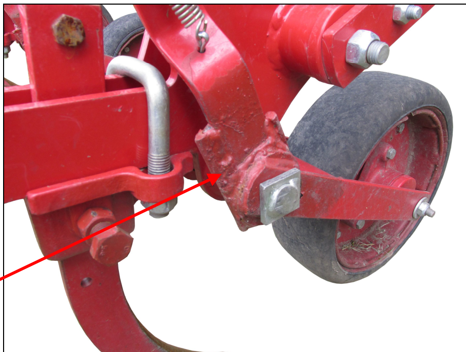
Рисунок А.2 – По месту излома стойки крепления копирующего колеса
