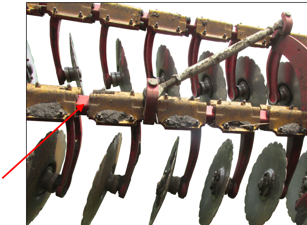
Рисунок А 3. – Балка крепления рабочих органов взамен изломанной
