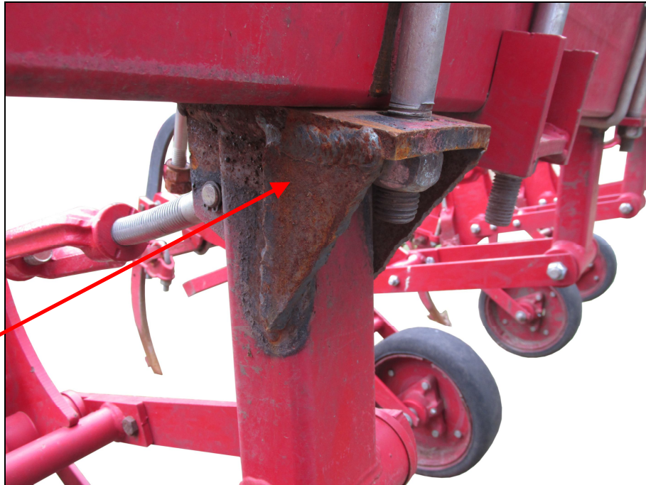
Рисунок А.1 – По месту обрыва стойки крепления рабочей секции
