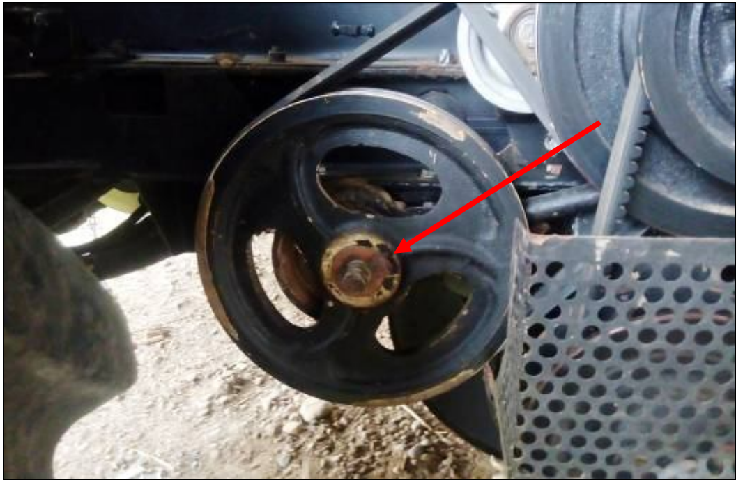
Рисунок А.1 – Колебательный вал очистки комбайна зерноуборочного РСМ-152 "ACROS-585" (после замены)
