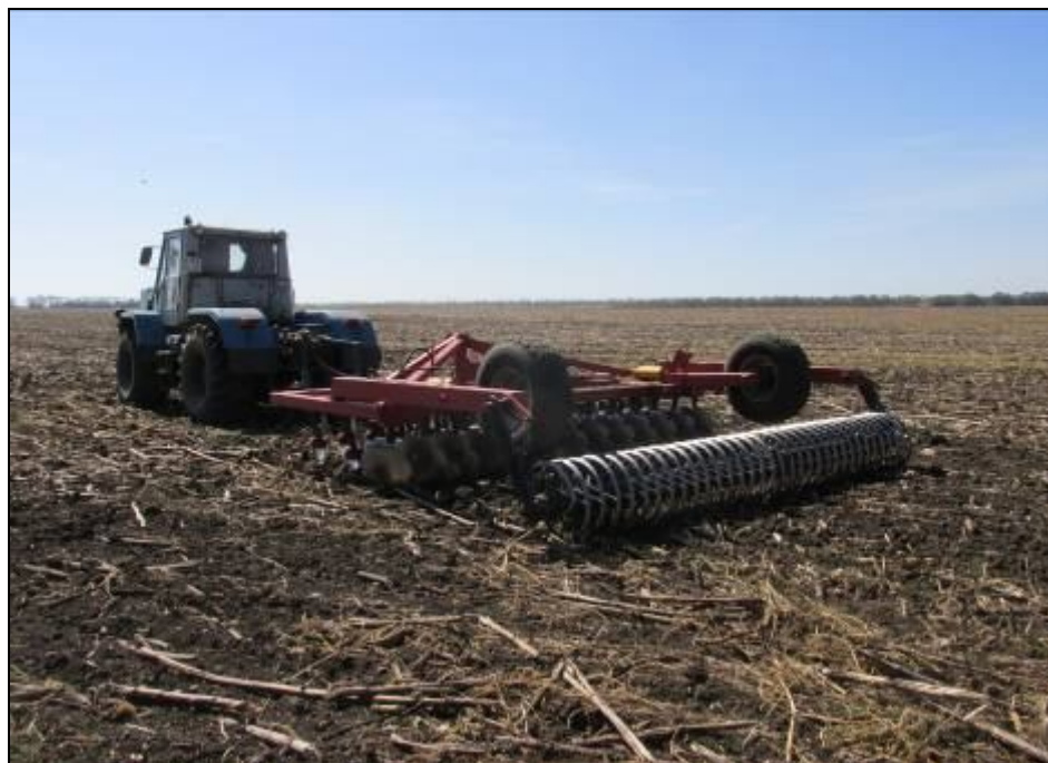
Рисунок 3 – Агрегат бороновальный дисковый АБД-4×3П в агрегате с трактором Т-150К, на дисковом лущении стерни подсолнечника (2 след)
