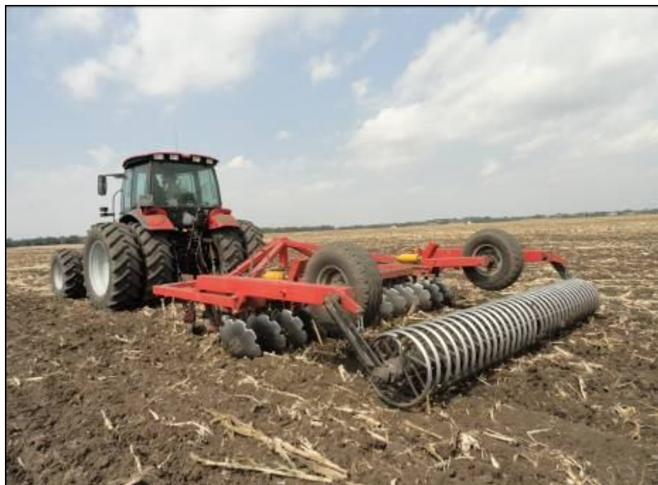
Рисунок 2 – Агрегат бороновальный дисковый АБД-4×3П в агрегате с трактором МТЗ 1523, на дисковом лущении стерни кукурузы (2 след)
