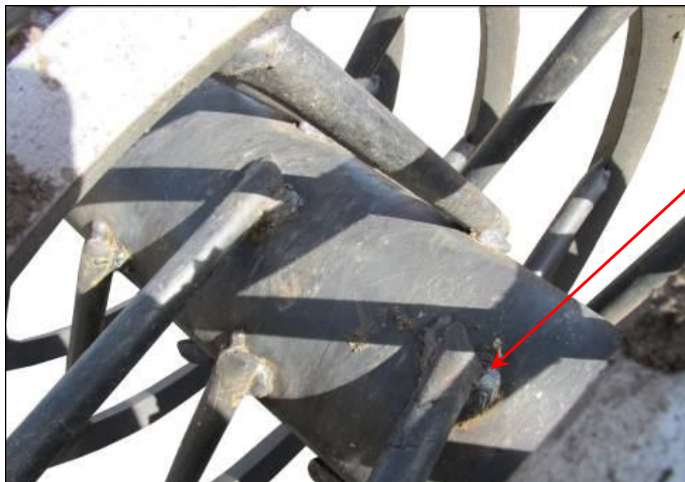
Рисунок А.1 – Сварка по месту обрыва спиралей катка
