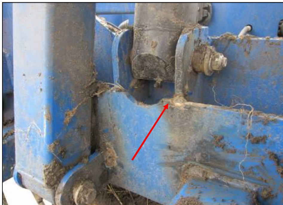
Рисунок А.3 – Сварка по месту разрыва (по сварному шву) проушины крепления гидроцилиндра
