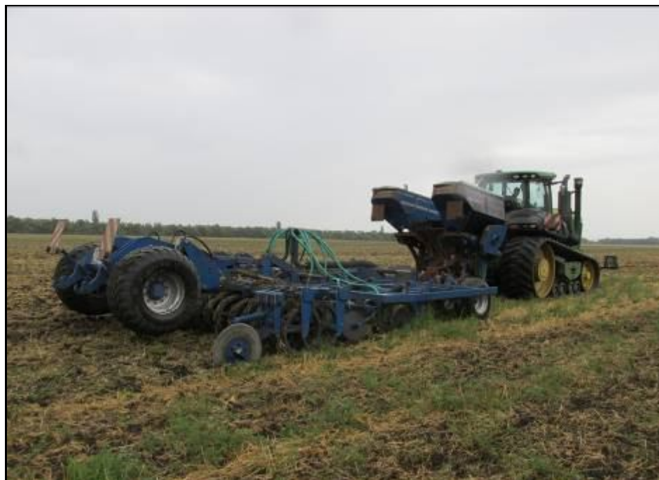
Рисунок 3 – Агрегат комбинированный Кöscherling Master 5.4/6.2, в агрегате с трактором John Deere 9520 RT, на комбинированной обработке почвы с внесением минеральных удобрений
