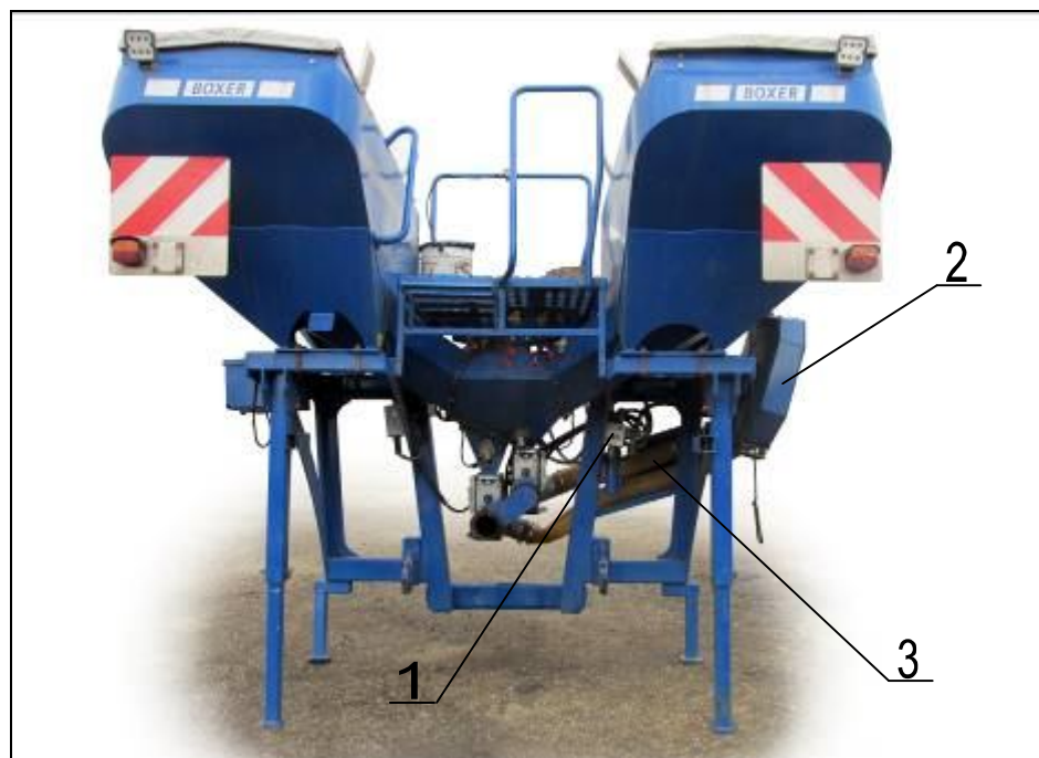
Рисунок 1 – Сдвоенный бункер Вохер: 1 - гидромотор; 2 - вентилятор; 3 - тукопроводы
