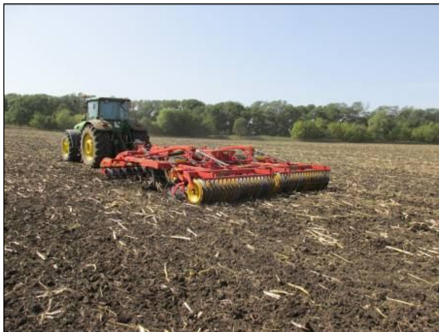
Рисунок 2 – Комбинированный агрегат Väderstad TD 500 в агрегате с трактором Джон Дир 8430, на комбинированной обработке почвы, после дискового лущения стерни кукурузы (фон 2)
