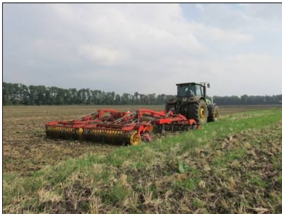
Рисунок 1 – Комбинированный агрегат Väderstad TD 500 в агрегате с трактором Джон Дир 8430, на комбинированной обработке почвы, после дискового лущения стерни озимой пшеницы (фон 1)
