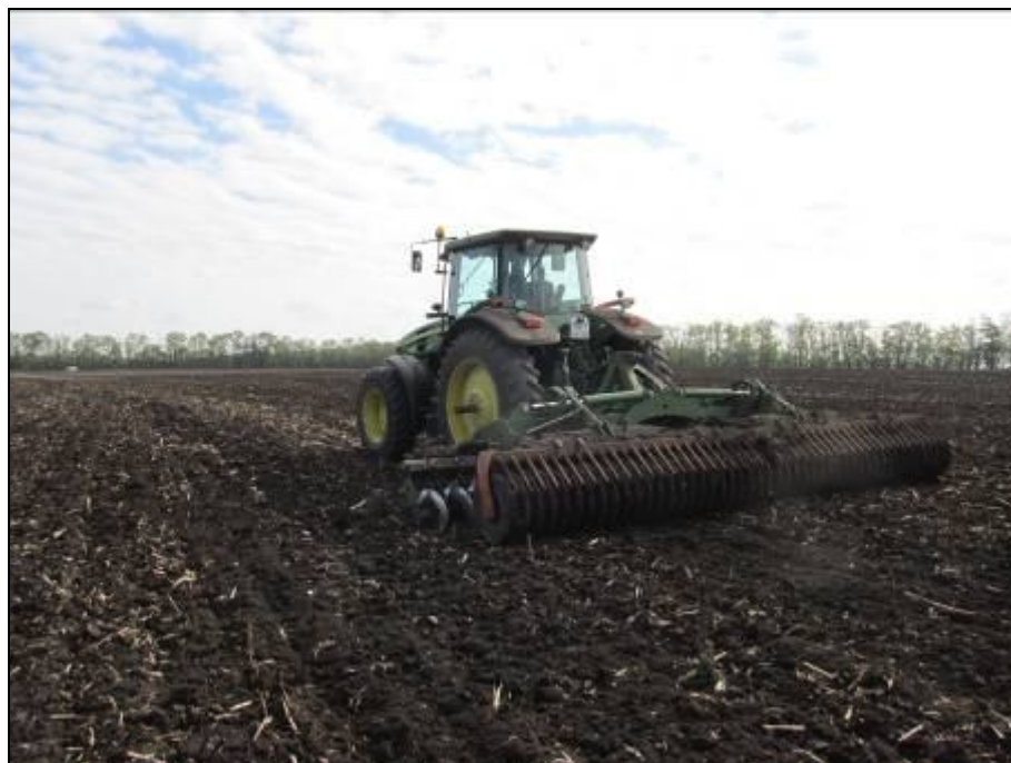
Рисунок 2 – Борона дисковая Amazone Catros 6001-2 в агрегате с трактором John Deere 7830 на дисковом лущении стерни кукурузы (2-й след)
