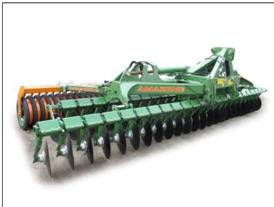
Рисунок 1 – Борона дисковая Amazone Catros 6001-2 в положении хранения, вид спереди справа
