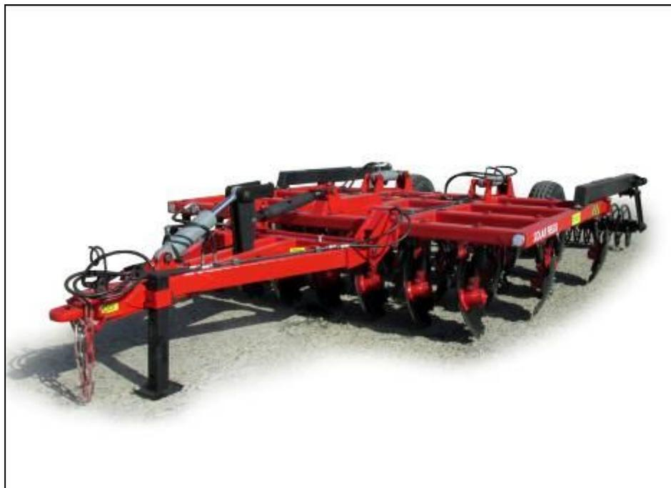
Рисунок 1 – Борона БДМ-3×4П в положении хранения, вид спереди слева
