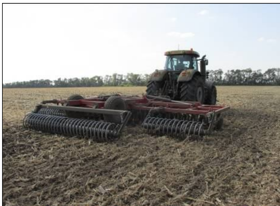
Рисунок 3 – Борона БДМ-7×3ПК в агрегате с трактором Challenger МТ685D, на дисковом лушении стерни кукурузы (2-й след)
