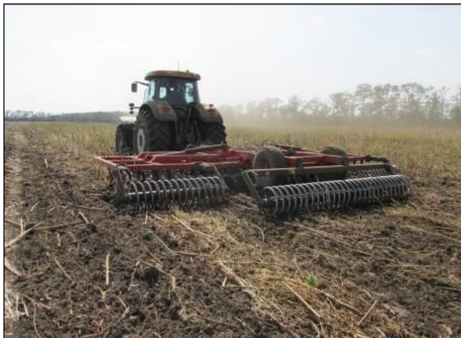
Рисунок 2 – Борона БДМ-7×3ПК в агрегате с трактором Challenger МТ685D, на дисковом лушении стерни подсолнечника (1-й след)
