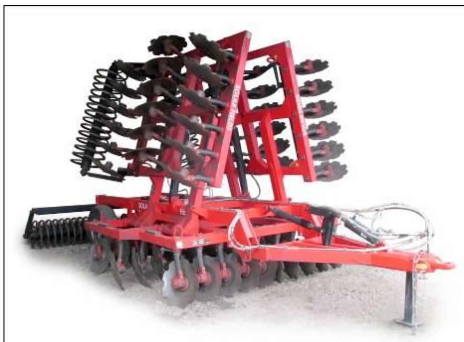
Рисунок 1 – Борона БДМ-7×3ПК в транспортном положении, вид спереди справа
