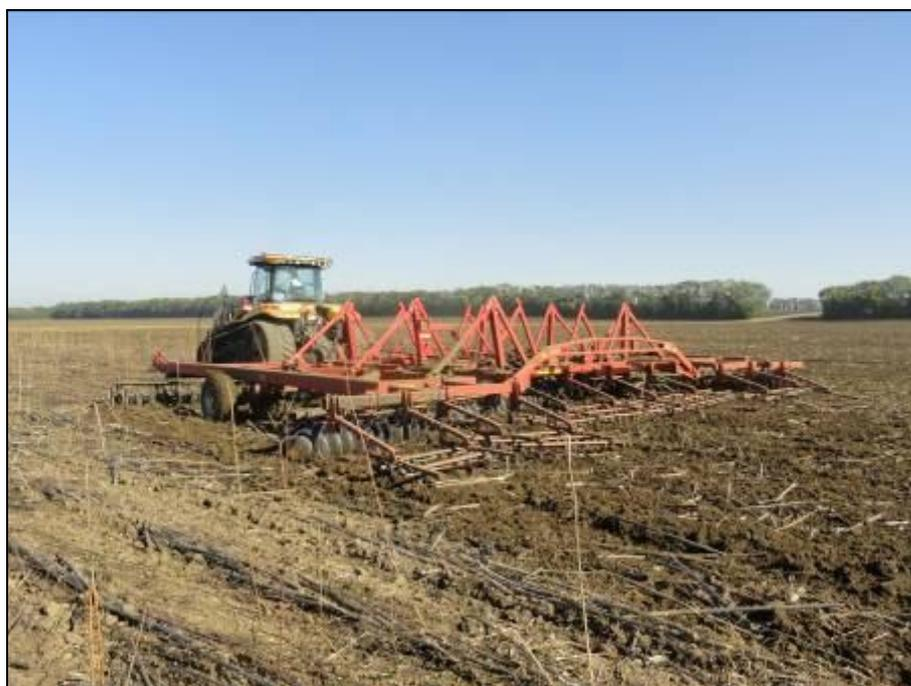
Рисунок 6 – Борона дисковая Challenger 1544-45 в агрегате с трактором Challenger МТ 865 С на дисковом лущении стерни подсолнечника (1-й след)
