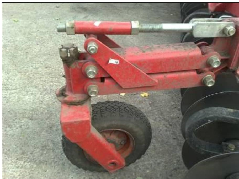
Рисунок 4 – Опорное колесо боковой секции с механизмом регулировки глубины обработки
