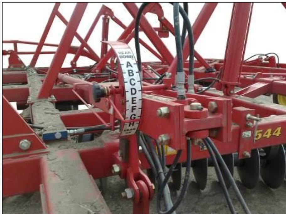
Рисунок 5 – Шкала регулятора глубины хода рабочих органов
