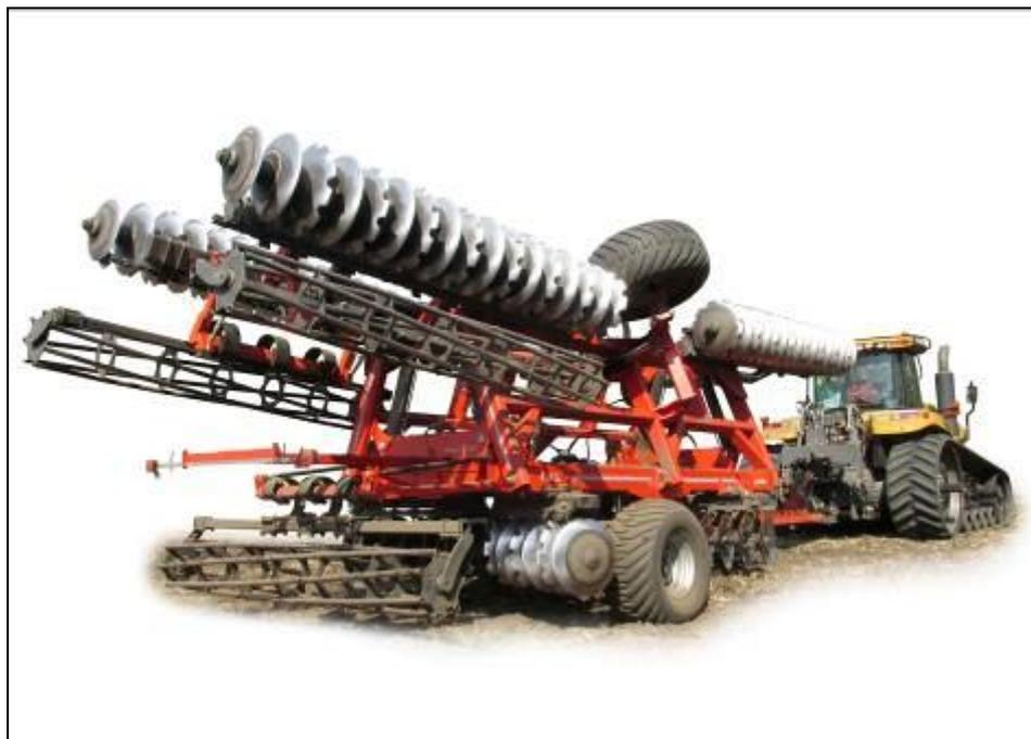
Рисунок 3 – Борона дисковая Gregoire Besson XXL в агрегате с трактором Challenger MT 865 С в транспортном положении
