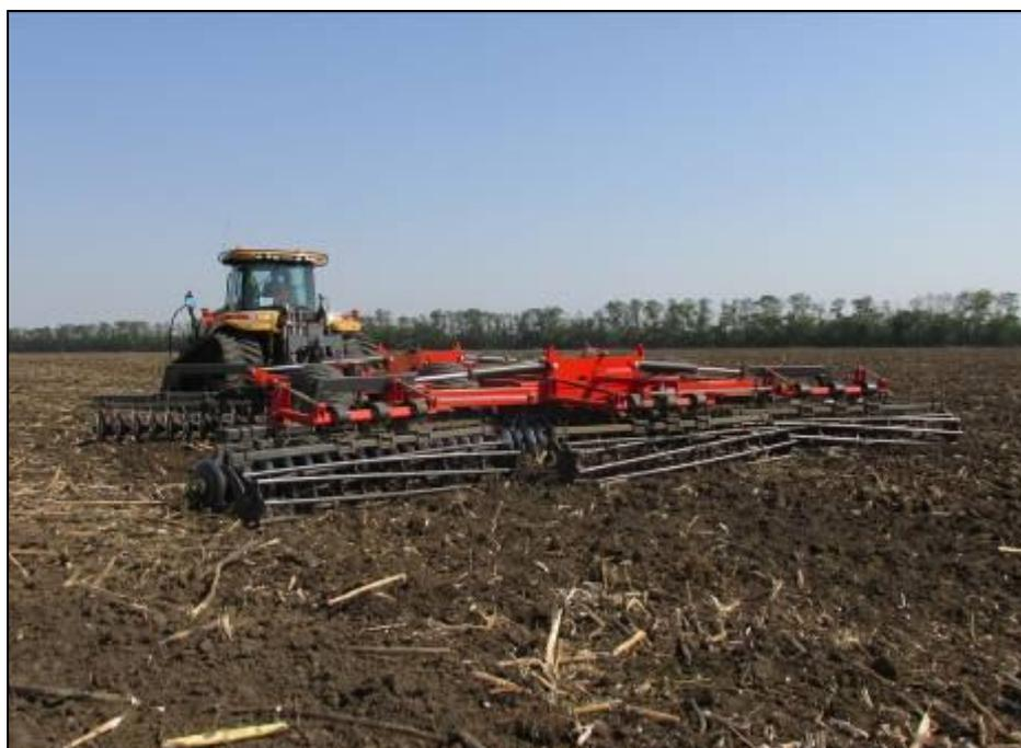
Рисунок 4 – Борона дисковая Gregoire Besson XXL в агрегате с трактором Challenger MT 865 С на дисковом лущении стерни подсолнечника (2 след)
