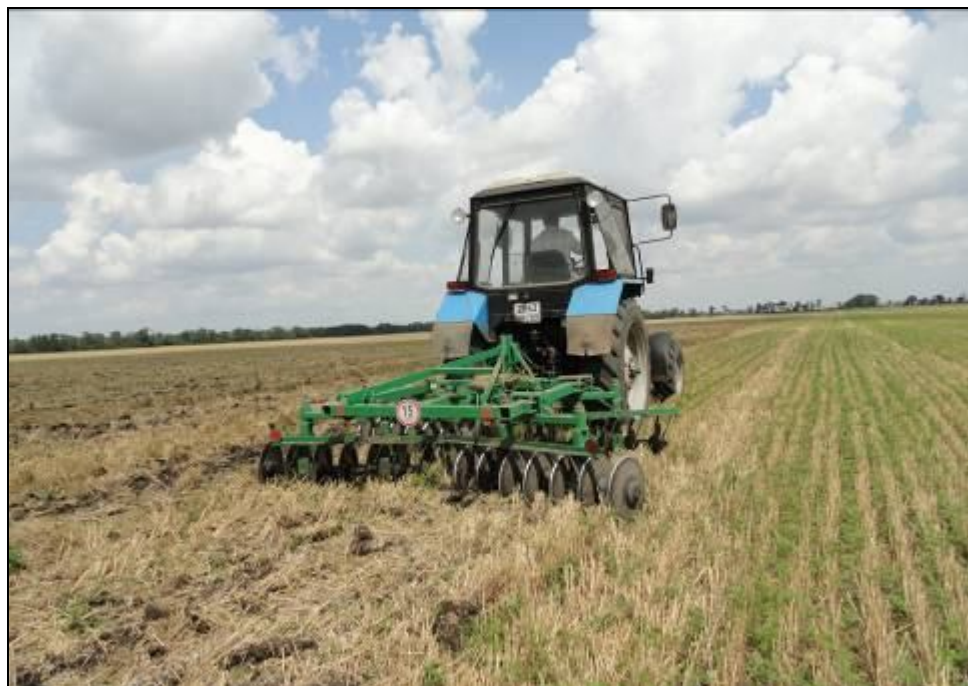
Рисунок 2 – Борона дисковая навесная БДН-3,2К в агрегате с трактором МТЗ-82.1 на дисковом лушении стерни озимой пшеницы
