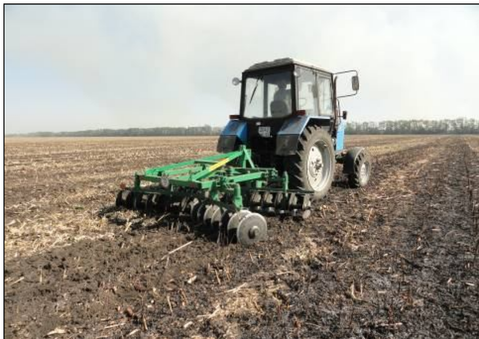
Рисунок 3 – Борона дисковая навесная БДН-3,2К в агрегате с трактором МТЗ-82.1 на дисковом лушении стерни кукурузы
