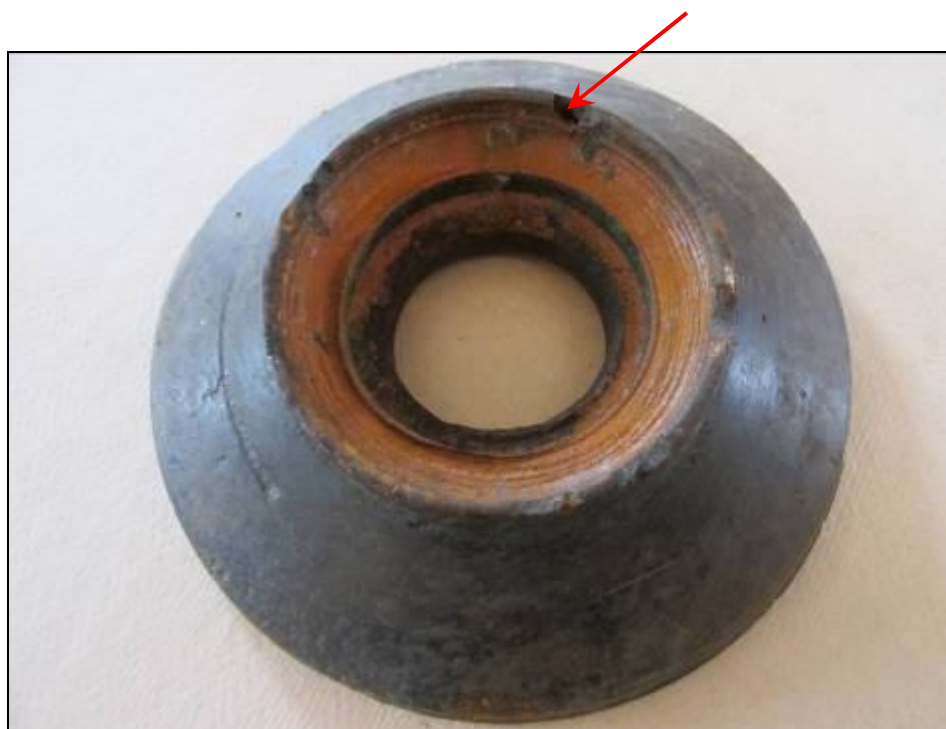
Рисунок А.2 – Наличие раковин в литье вогнутого упора
