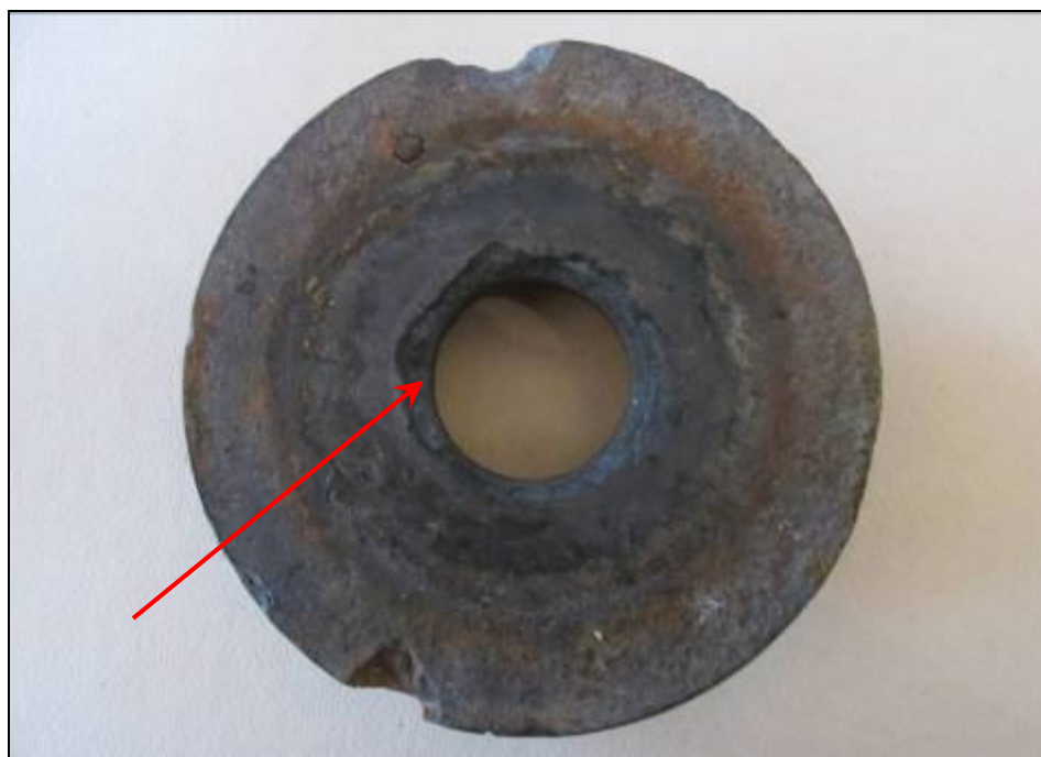
Рисунок А.1 – Разрушение отверстия вогнутого упора крепления подшипникового узла (наличие раковин)
