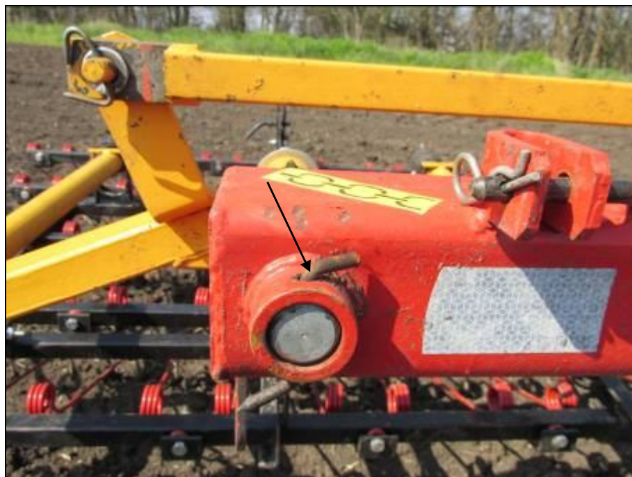
Рисунок А.1 – Срез шплинта узла крепления боковых секций рабочих органов
