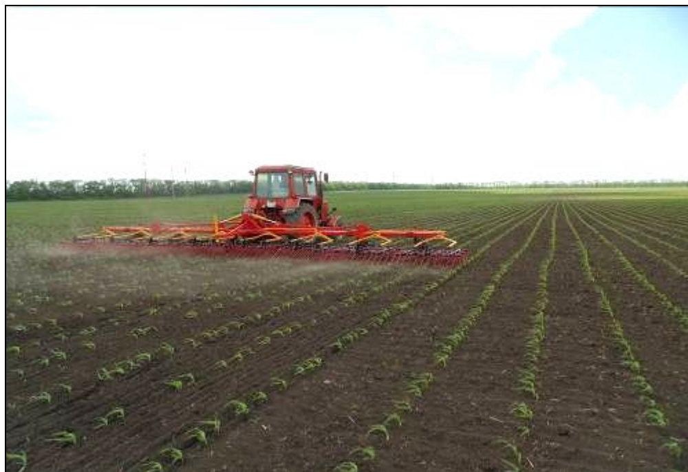
Рисунок 7 – Борона штригельная БШ-12Н в агрегате с трактором МТЗ-80, на повсходовом бороновании посевов кукурузы, вид в работе
