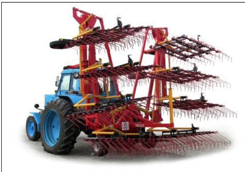
Рисунок 4 – Борона штригельная БШ-12Н в агрегате с трактором МТЗ-82, в транспортном положении, вид сзади слева
