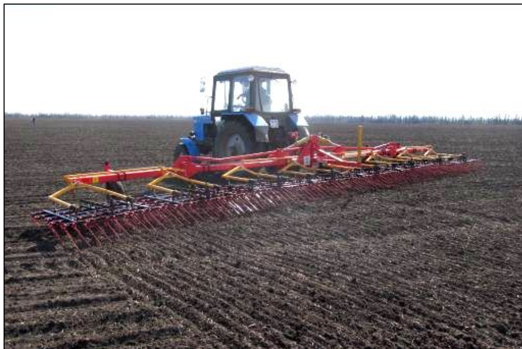
Рисунок 5 – Борона штригельная БШ-12Н в агрегате с трактором Беларус 82.1 в работе, на довсходовом бороновании посевов кукурузы
