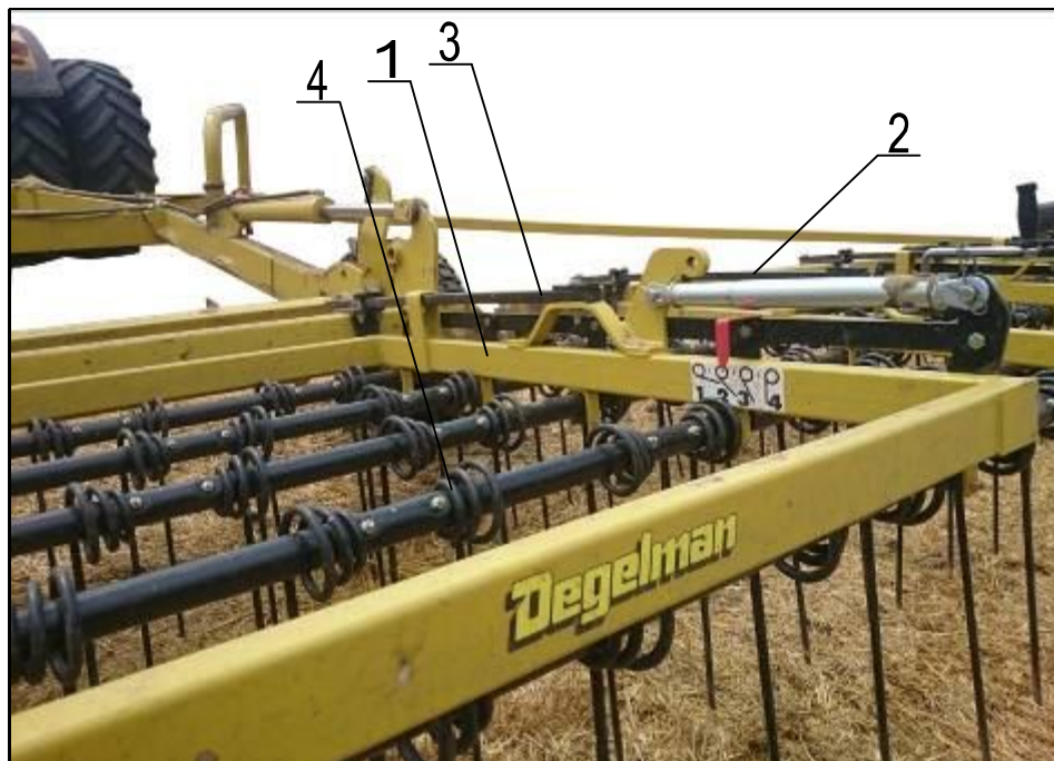
Рисунок 2 – Механизм регулирования угла наклона штригелей: 1 - секция рабочих органов; 2 - винтовой домкрат; 3 - поперечная штанга; 4 - штригель
