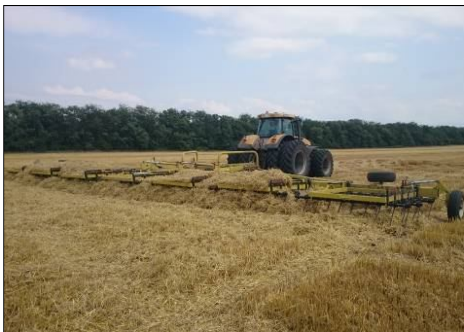
Рисунок 3 – Борона штригельная Strawmaster 7000 в агрегате с трактором Challenger MT 685C, на распределении соломы по полю
