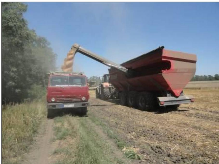
Рисунок 4 – Бункер-накопитель Interbenne 39
