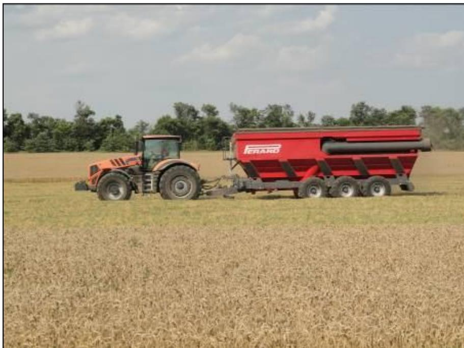
Рисунок 3 – Бункер-накопитель Interbenne 39
