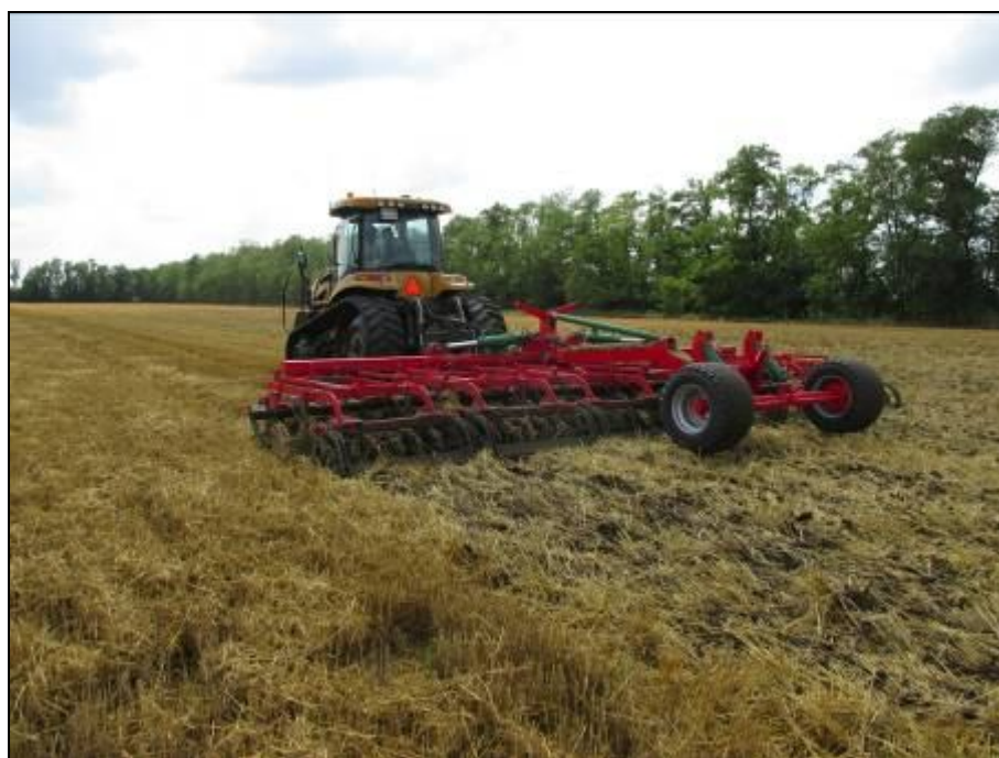
Рисунок 4 – Дисковый лушительник МАХ 9.0 Т в агрегате с трактором Challenger МТ765С на дисковом лушении стерни озимой пшеницы
