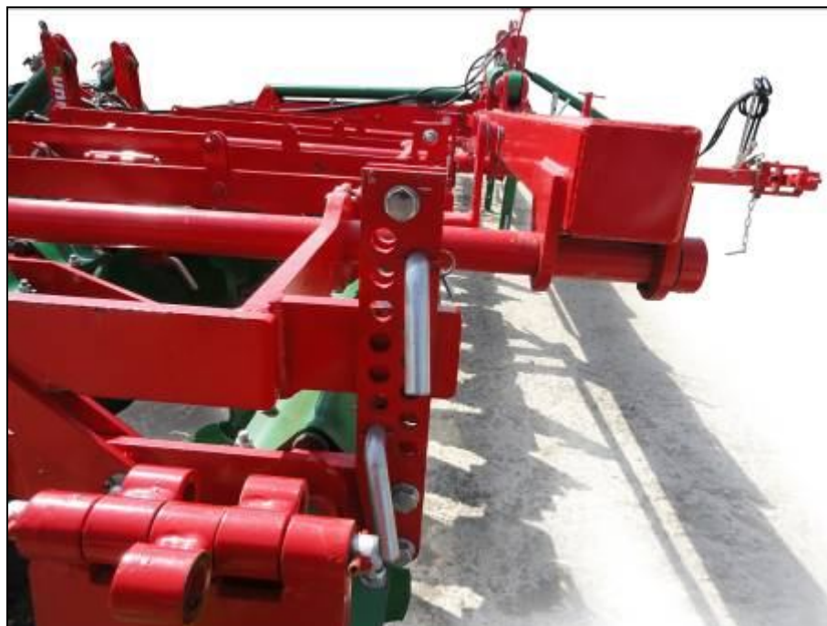
Рисунок 3 – Регулировка изменения глубины хода рабочих органов
