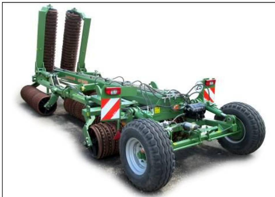
Рисунок 1 – Каток Amazone AW 15400 в положении хранения, вид сзади слева
