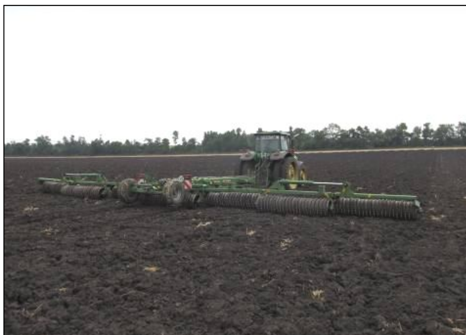
Рисунок 2 – Каток Amazone AW 15400 в агрегате с трактором Джон Дир 7830, на прикатывании почвы
