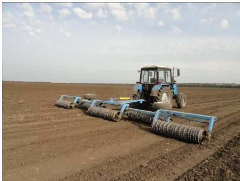
Рисунок 2 – Каток ККЗ-9,2Н-01 в агрегате с трактором Беларус 952 на прикатывании почвы под посев
