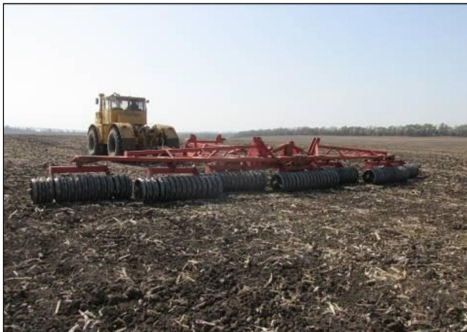
Рисунок 2 – Каток кольчато-зубчатый БУЛАВА КЗ-12,4
