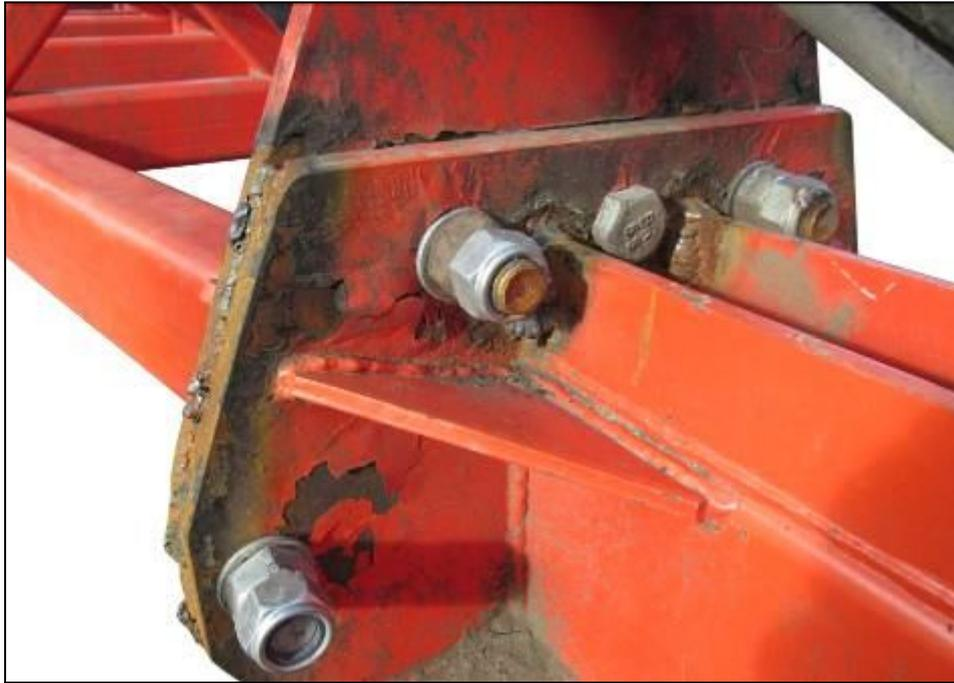
Рисунок А.1 – Обрыв по сварке ребер жесткости пластины крепления прицепной снлицы
