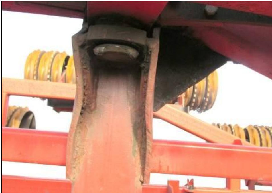
Рисунок А.2 – Обрыв по сварке косынки крепления секции рамы
