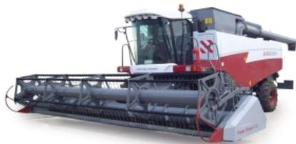
Комбайн зерноуборочный РСМ-152 «ACROS 590 Plus», двигатель CUMMINS (325 л.с.) предназначен для уборки зерновых колосовых культур на равнинных полях с уклоном не более 8° во всех зерносеющих зонах страны прямым и отдельным комбайнированием.
