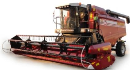
Комбайн зерноуборочный самоходный КЗС-1218 "Палессе GS12" предназначен для прямой и раздельной уборки зерновых колосовых культур, а с применением специальных приспособлений для уборки зерновой части кукурузы, подсолнечника, зернобобовых, крупяных культур, семенников трав и рапса на равнинных полях с уклоном до 8°.
