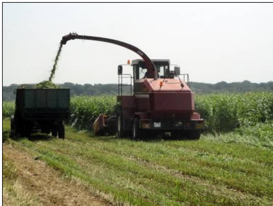
Рисунок 9 – Комбайн кормоуборочный самоходный высокопроизводительный КВК-800-39, в агрегате с жаткой для уборки трав КВК-6025.12-02, в работе на скашивании суданской травы
