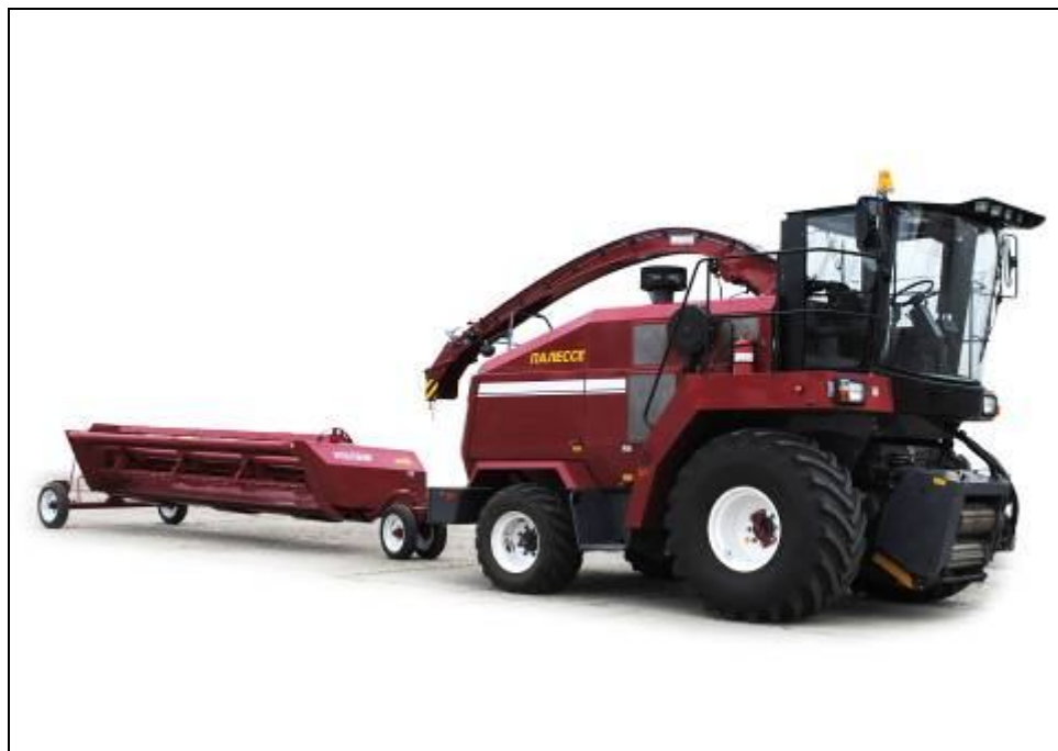
Рисунок 4 – Комбайн кормоуборочный самоходный высокопроизводительный КВК-800-39, в агрегате с жаткой для уборки трав КВК-6025.12-02, (с транспортной тележкой) в транспортном положении, вид спереди справа
