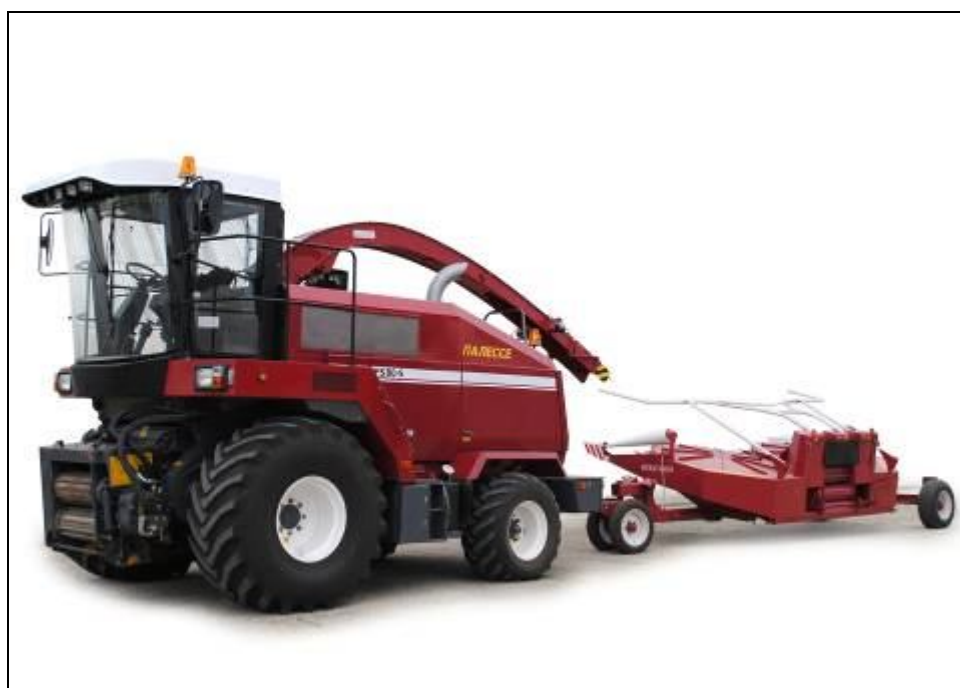
Рисунок 7 – Комбайн кормоуборочный самоходный высокопроизводительный КVK-800-39, в агрегате с жаткой для уборки грубостебельных культур ЖГР-4,5-1Е (установленной на транспортную тележку), в транспортном положении, вид спереди слева
