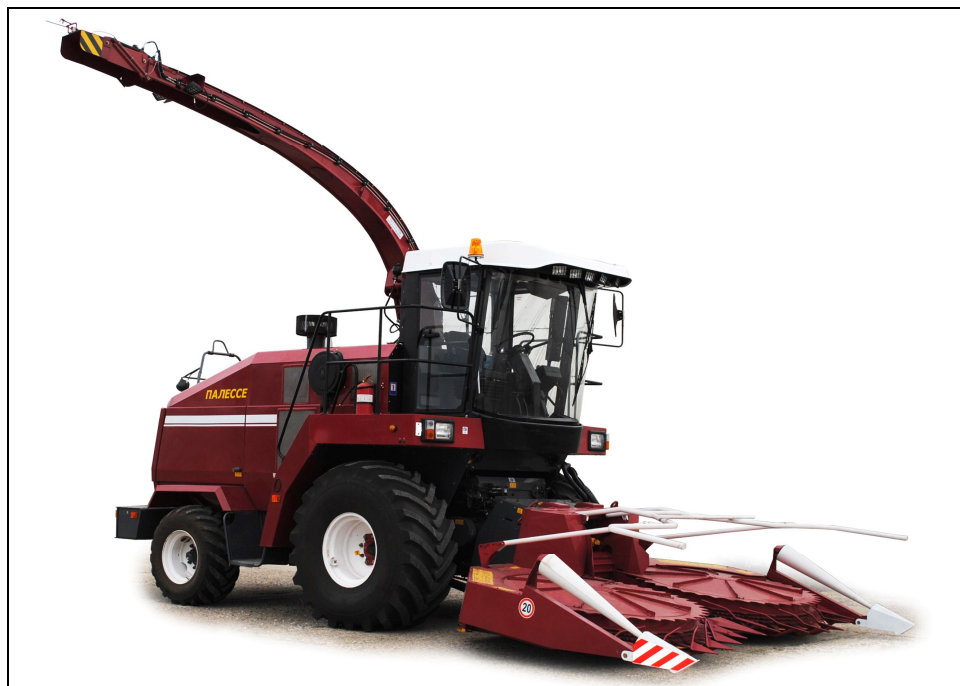
Рисунок 6 – Комбайн кормоуборочный самоходный высокопроизводительный КVK-800-39, в агрегате с жаткой для уборки грубостебельных культур ЖГР-4,5-1Е, в рабочем положении, вид спереди справа
