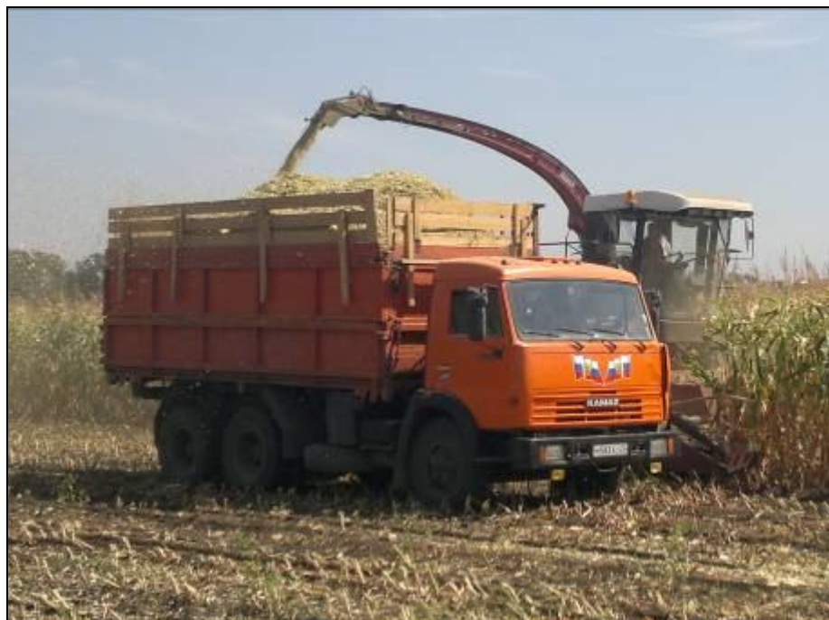
Рисунок 10 – Комбайн кормоуборочный самоходный высокопроизводительный КВК-800-39, в агрегате с жаткой для уборки грубостебельных культур ЖГР-4,5-1Е, в работе на скашивании кукурузы на силос
