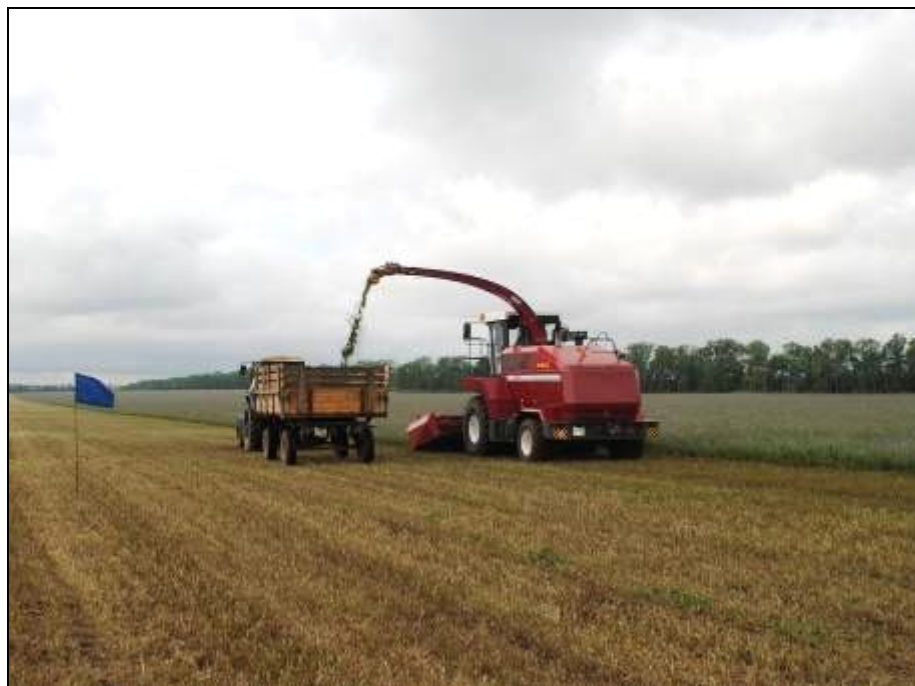
Рисунок 8 – Комбайн кормоуборочный самоходный высокопроизводительный КВК-800-39, в агрегате с жаткой для уборки трав КВК-6025.12-02, в работе на скашивании люцерны
