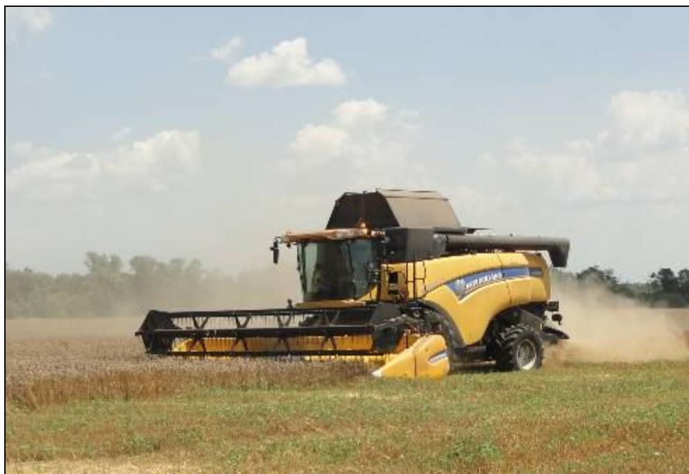
Рисунок 4 – Комбайн зерноуборочный New Holland CX 8080 на прямом комбайнировании озимой пшеницы
