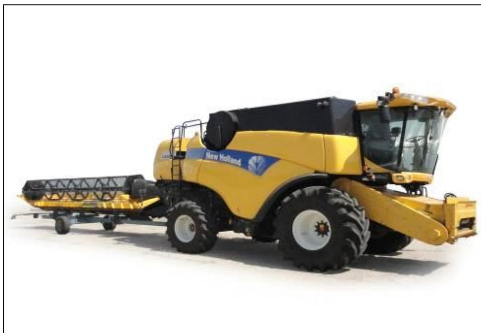
Рисунок 2 – Комбайн зерноуборочный New Holland CX 8080 в агрегате с тележкой транспортной с установленной жаткой (дальний транспорт), вид спереди справа
