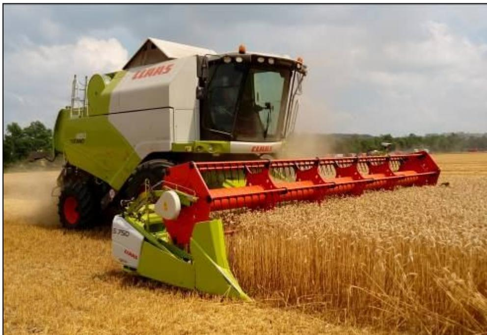
Рисунок 2 – Комбайн зерноуборочный Тисано 480 с жаткой S 750 CLAAS на прямом комбайнировании озимой пшеницы
