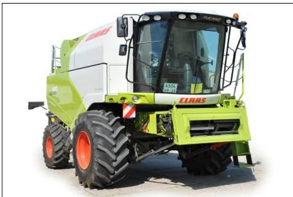
Рисунок 1 – Комбайн зерноуборочный Тусано 480, вид спереди справа
