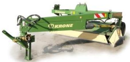
Косилка-плющилка Easu Cut 3200 CV предназначена для скашивания высокоурожайных и полеглых трав с одновременным плющением скошенной массы и укладкой ее в валок.
