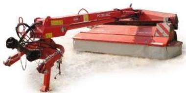
Косилка полуприцепная FC 353 RGC предназначена для скашивания высокоурожайных и полеглых трав с одновременным плющением скошенной массы и укладкой ее в валок.
