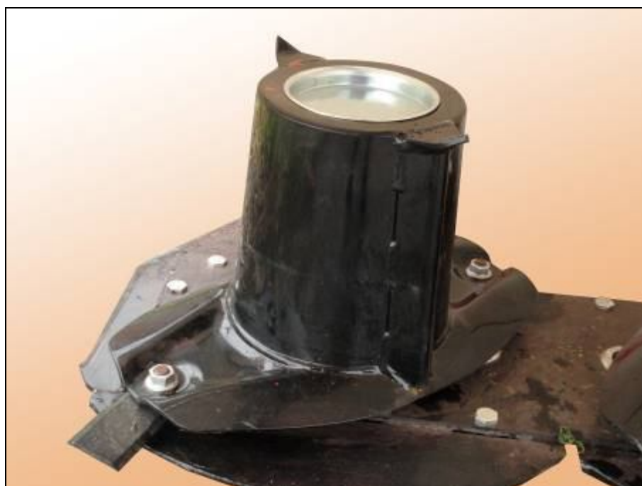
Рисунок 4 – Крайний диск ротора с установкой двух ножей
