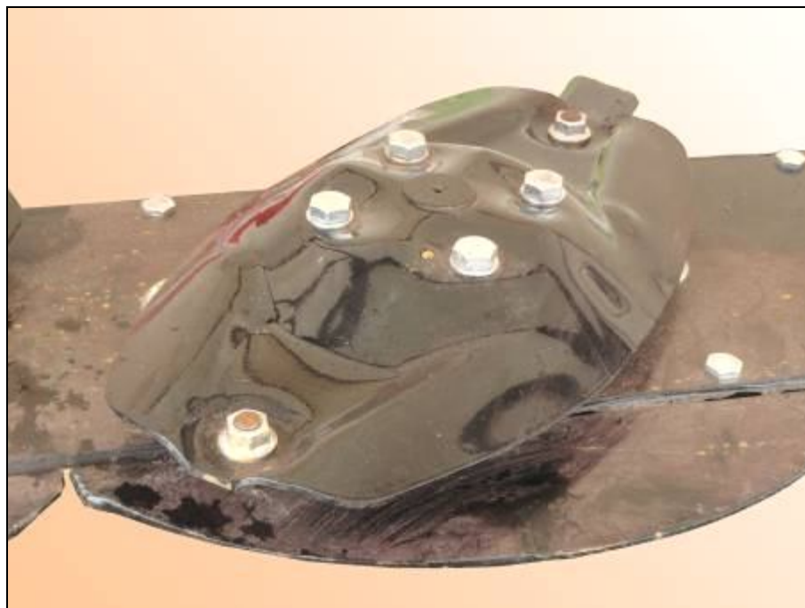
Рисунок 3 – Диск бруса режущего с установкой двух ножей
