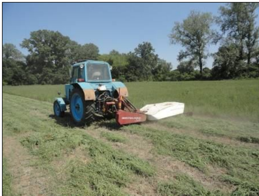
Рисунок 7 – Косилка ротационная навесная ЖТТ-2,4 в агрегате с трактором МТЗ-80 на покосе люцерны
