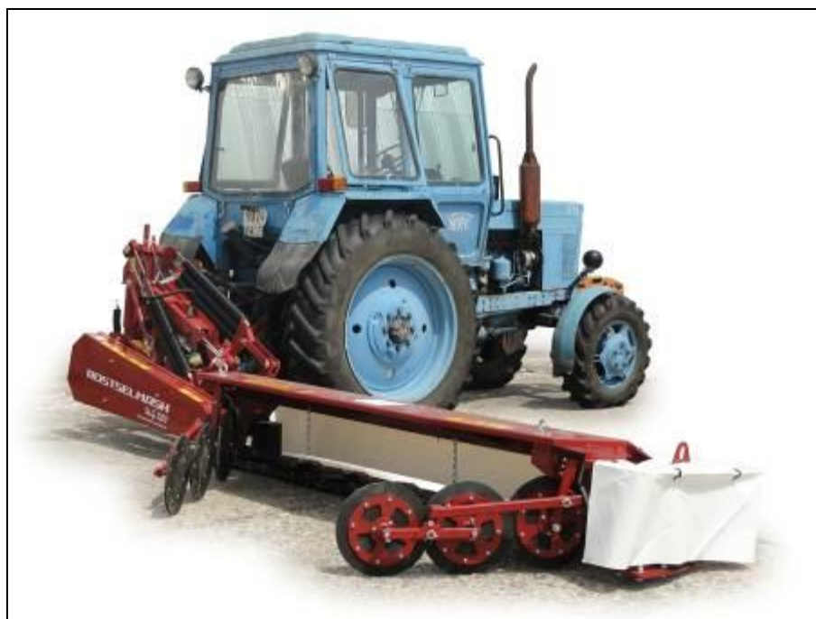
Рисунок 4 – Косилка ротационная навесная ЖТТ-3,2 в агрегате с трактором МТЗ-82 в рабочем положении, вид сзади справа
