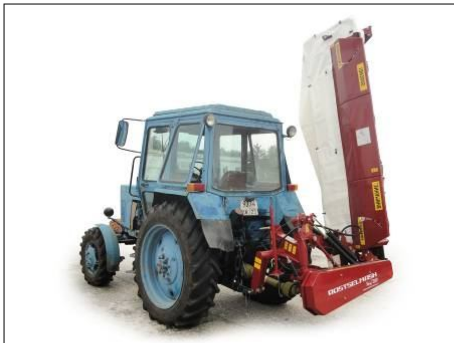
Рисунок 3 – Косилка ротационная навесная ЖТТ-3,2 в агрегате с трактором МТЗ-82 в транспортном положении, вид сзади слева
