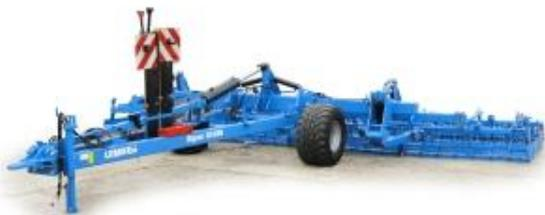
Системный носитель Гигант 10/800 предназначен для составления широкозахватных агрегатов. Системный носитель Гигант 10/800 оснащен гидравлическими трехточечными навесками, на которые навешиваются орудия (культиватор Система-Компактор С-400 (2 образца)). Агрегат предназначен для предпосевной подготовки почвы и обеспечивает независимую работу отдельных рабочих секций.
