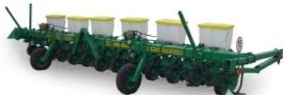
Культиватор-растениепитатель навесной свекловичный 12-рядный КРНС-5,4 "Корммаш" предназначен для междурядной обработки и подкормки посевов свеклы, сои и других пропашных культур с междурядьями 45 см, во всех почвенно-климатических зонах при влажности почвы 8-28 % и твердости 0,4-1,6 МПа в горизонтах от 0 до 15 см на полях с ровным и волнистым до 8° рельефом местности. Культиватор агрегируется с тракторами тягового класса 1,4-2,0 (МТЗ-80/82, ЮМЗ-6А116АМ, ЛТЗ-145, Т-142).
