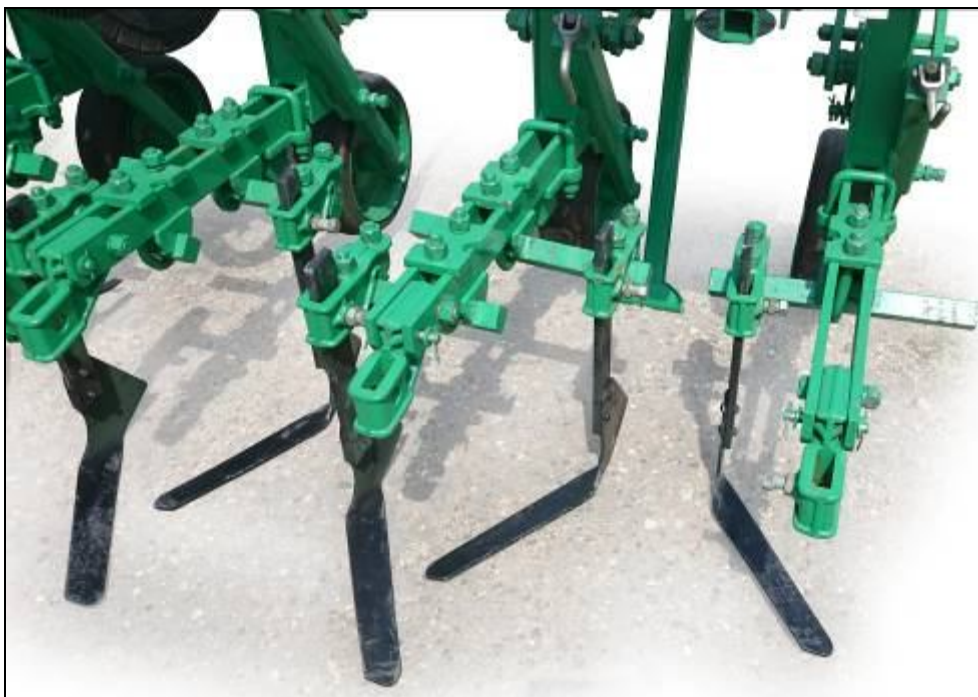
Рисунок 5 – Секция рабочих органов с лапами полольными односторонними
