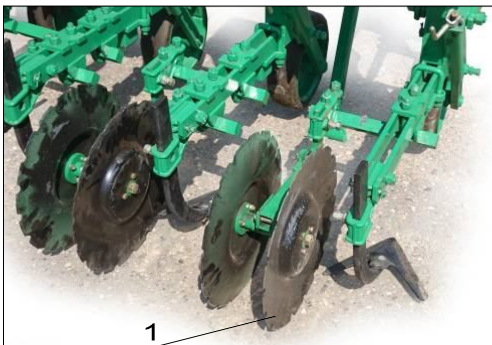
Рисунок 4 – Секция рабочих органов с защитными дисками и стрельчатой лапой:
