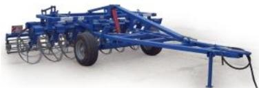
Культиватор ротационный КР-4К "Кротор" предназначен для подрезания и выноса сорной растительности на поверхность поля, крошения и измельчения комьев и пожнивных остатков, рыхления, мульчирования, выравнивания и уплотнения верхнего слоя почвы в целях сохранения влаги и питательных веществ во время сплошной предпосевной и паровой культивации полей.
