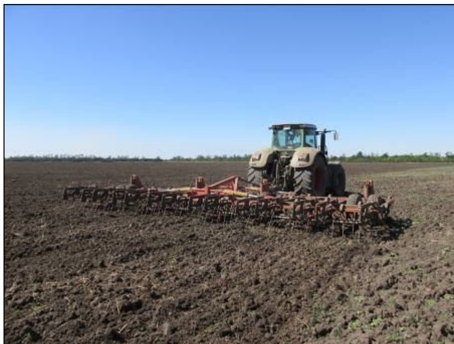
Рисунок 1 – Культиватор БПК-10 в агрегате с трактором Fendt 936 на сплошной культивации почвы
