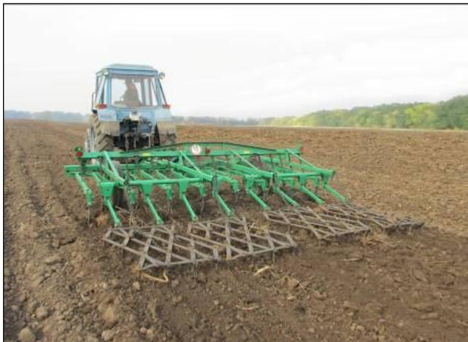
Рисунок 2 – Культиватор для сплошной обработки почвы КПС-4У в агрегате с трактором МТЗ-82, на предпосевной обработке почвы
