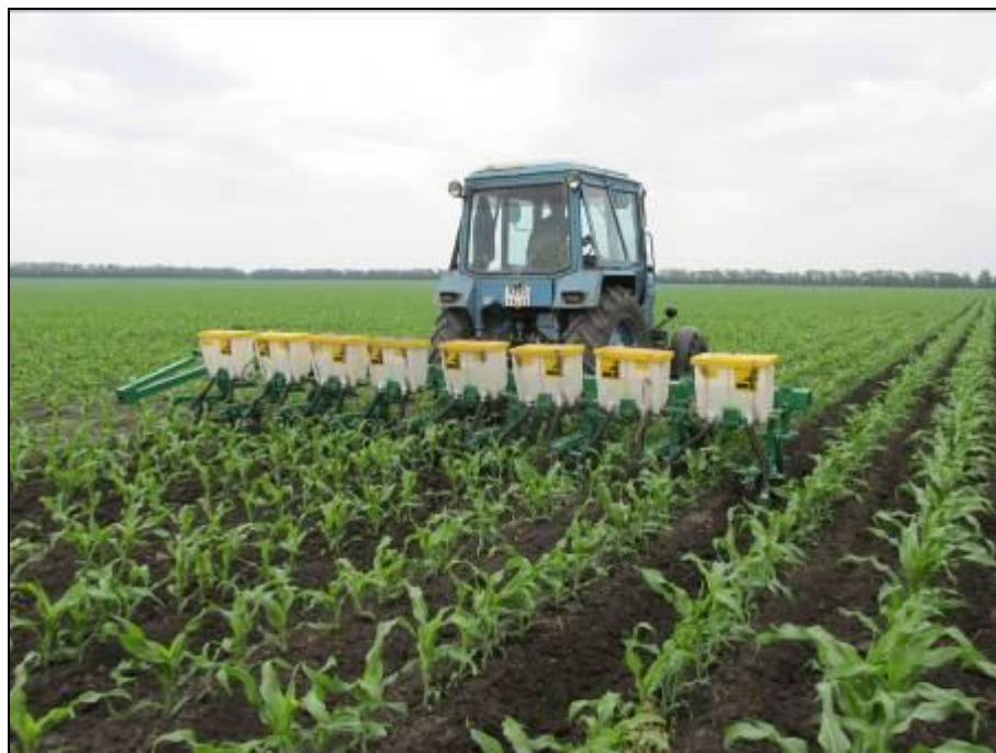
Рисунок 2 – Культиватор КРН-5,6К в агрегате с трактором МТЗ-82, на междурядной культивации посевов кукурузы
