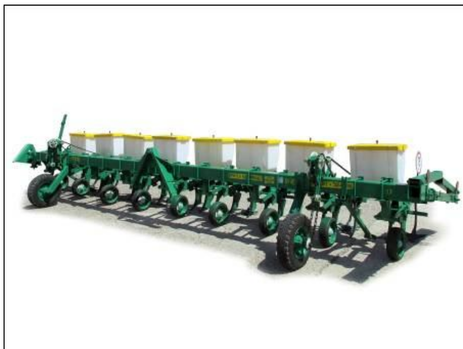
Рисунок 1 – Культиватор КРН-5,6К в рабочем положении, вид спереди слева
