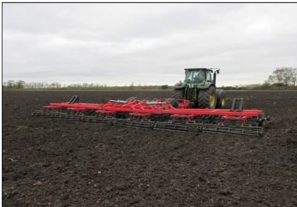
Рисунок 2 – Культиватор КШМ-10,8 в агрегате с трактором John Deere 7830, на сплошной культивации почвы (2-й след)
