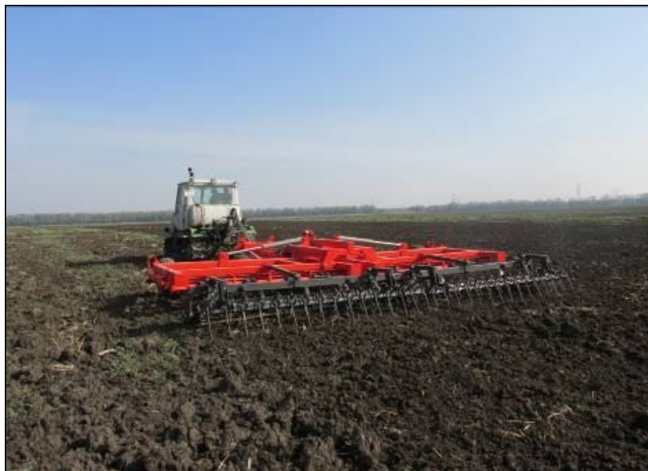
Рисунок 4 – Культиватор КСМ-6 в агрегате с трактором Т-150, на культивации почвы после вспашки
