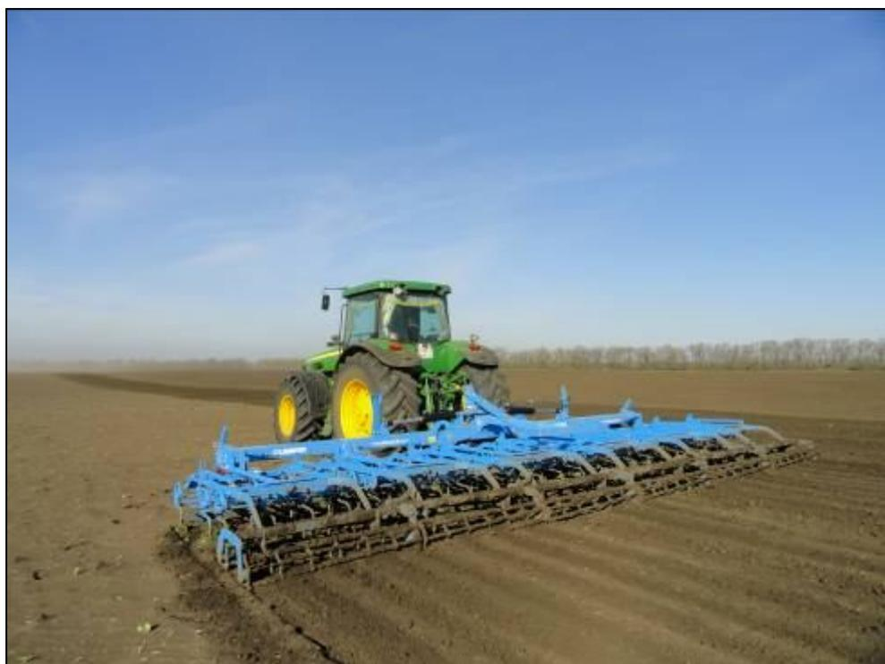
Рисунок 4 – Культиватор Lemken Korund 8/900 К в агрегате с трактором John Deere 8420, на предпосевной культивации почвы под посев озимой пшеницы
