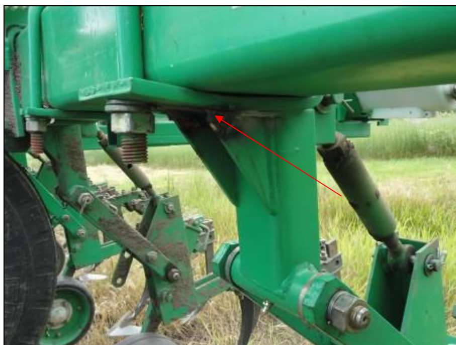
Рисунок А.2 – Трещина по сварному соединению ребра жесткости и присоединительной пластины рабочей секции к раме
