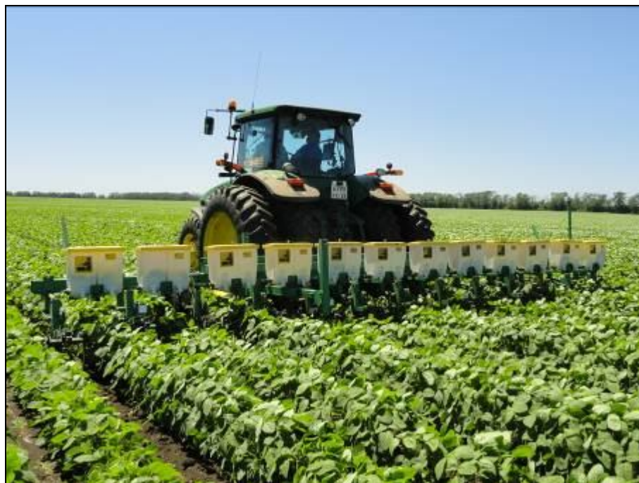
Рисунок 4 – Культиватор КРН- 8,4К в агрегате с трактором John Deere 7830 на междурядной культивации посевов сои
