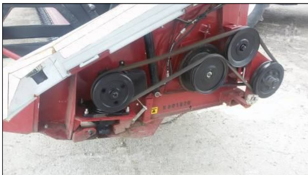
Рисунок 2 – Механизм привода ножа МПН 85.20ПБ 000 0120 Р1, установленный на жатку РСМ -081.27-49.
