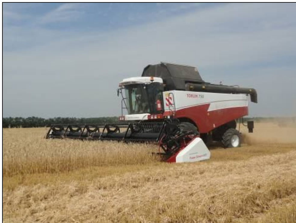
Рисунок 7 – Механизм привода ножа МПН 85.20ПБ 000 0120 Р1 и режущий аппарат Р 880.00.000.А-08, установленные на жатку РСМ -081.27-49 комбайна зерноуборочного TORUM-750 в работе на уборке озимой пшеницы
