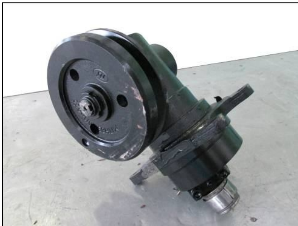
Рисунок 1 – Механизм привода ножа МПН 85.20ПБ 000 0120 Р1
