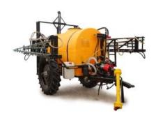
Опрыскиватель навесной ОН-12 предназначен для внесения химических средств защиты растений, жидких комплексных и других жидких минеральных удобрений путем поверхностного опрыскивания.
