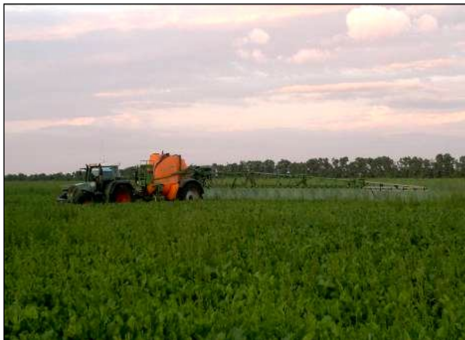
Рисунок 3 – Опрыскиватель Amazone UX 6200 в работе, в агрегате с трактором FENDT-716 на опрыскивании посевов сахарной свеклы
