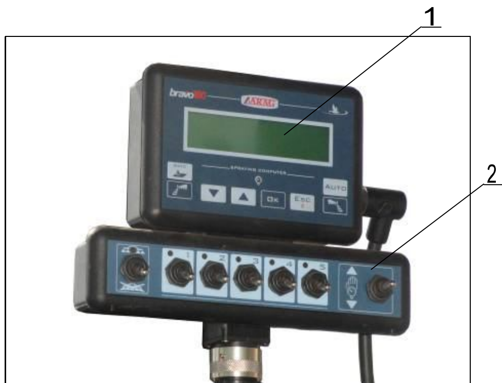
Рисунок 2 – Панель электронного управления опрыскивателя полуприцепного BARGAM ELIOS BDL 3000: 1 - монитор; 2 - переключатель режима работы
