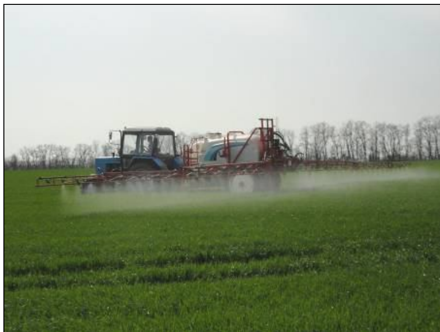
Рисунок 3 – Опрыскиватель полуприцепной BARGAM ELIOS BDL 3000 в работе, в агрегате с трактором МТЗ-82.1 на опрыскивании посевов озимой пшеницы
