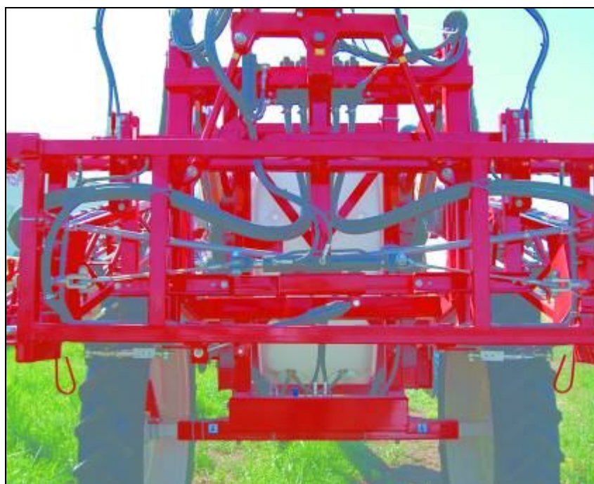
Рисунок 4 – Параллелограмная система подъема и опускания штанг
