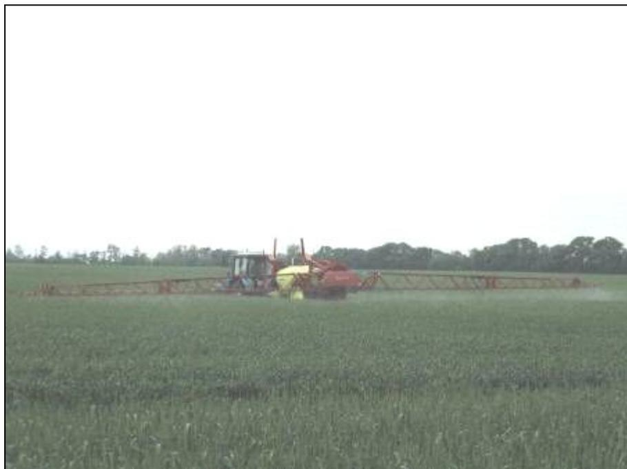
Рисунок 4 – Опрыскиватель полуприцепной IXTRACK A28 в агрегате с трактором МТЗ-82 на обработке посевов озимой пшеницы
