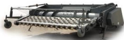
Платформа для подборщика РСМ 081.08.01 предназначена для монтажа на ней подборщика транспортного МСМ 10.08.07 для подбора валков зерновых колосовых, зернобобовых, крупяных культур и риса при раздельной их уборке в условиях умеренного климата.
