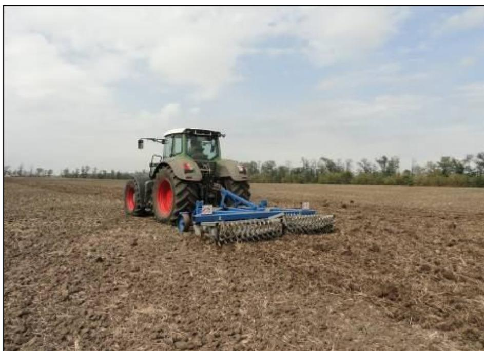
Рисунок 3 – Плуг ПЧН-4,0ЕК в агрегате с трактором Fendt 936, на чизелевании почвы после дискового лущения стерни озимой пшеницы в два следа (фон 2)
