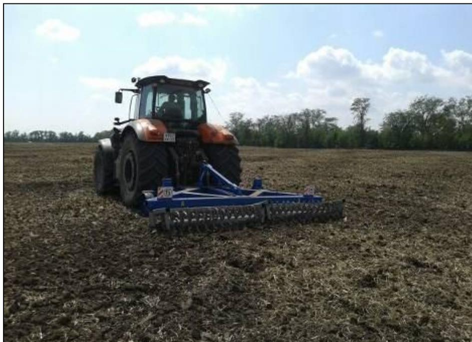
Рисунок 2 – Плуг ПЧН-4,0ЕК в агрегате с трактором АТМ 7360, на чизелевании почвы после дискового лущения стерни озимой пшеницы в два следа (фон 1)
