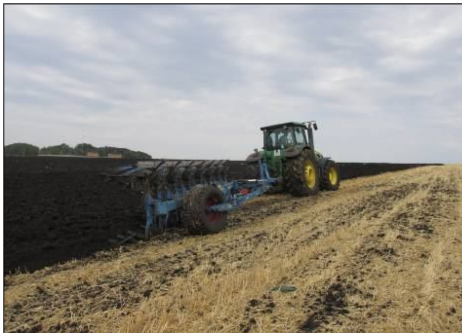
Рисунок 3 – Плуг Lemken Евро Диамант 10 7+1 в агрегате с трактором Джон Дир 8430, на отвальной вспашке почвы (фон 2)
