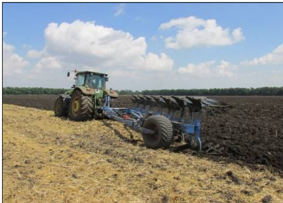
Рисунок 2 – Плуг Lemken Евро Диамант 10 7+1 в агрегате с трактором Джон Дир 8430, на отвальной вспашке почвы (фон 1)
