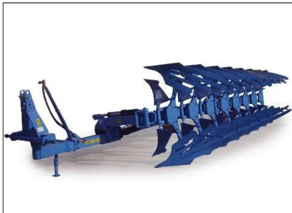
Рисунок 1 – Плуг Lemken Евро Диамант 10 7+1, в положении хранения, вид спереди слева
