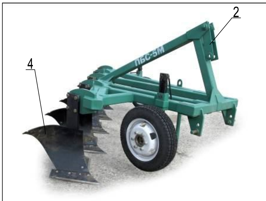
Рисунок 1 – Плуг ПБС-5М, вид спереди справа: 2 - навеска; 4 - корпус
