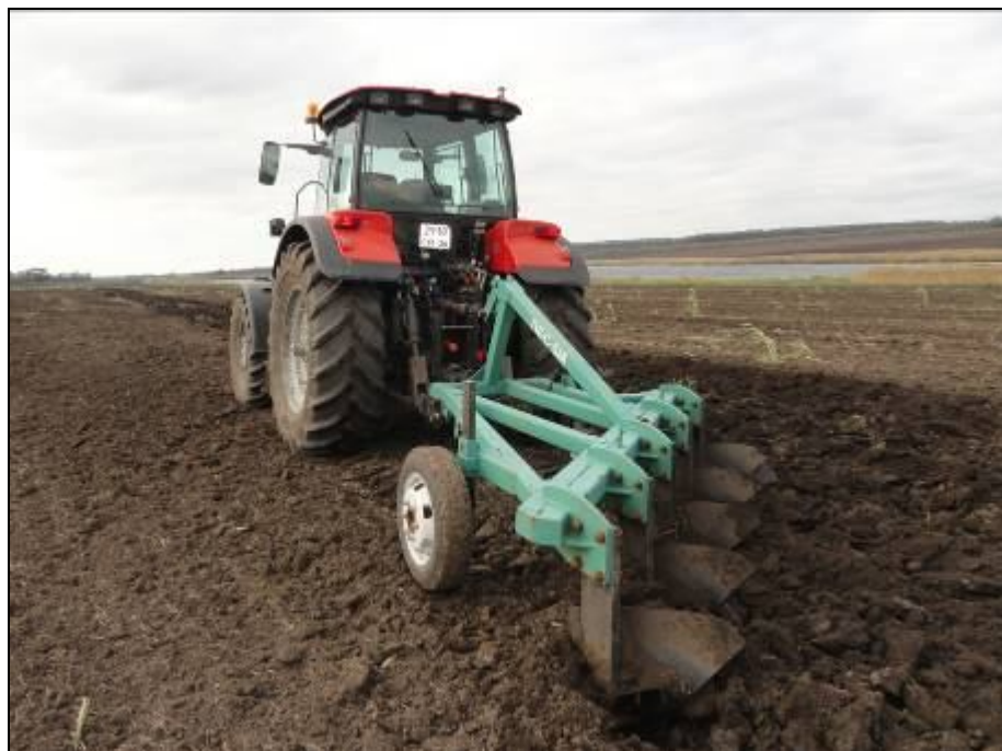
Рисунок 6 – Плуг ПБС-5М в агрегате с трактором Беларус 3022 ДЦ1 на вспашке почвы после 3-х кратного дискования стерни озимой пшеницы
