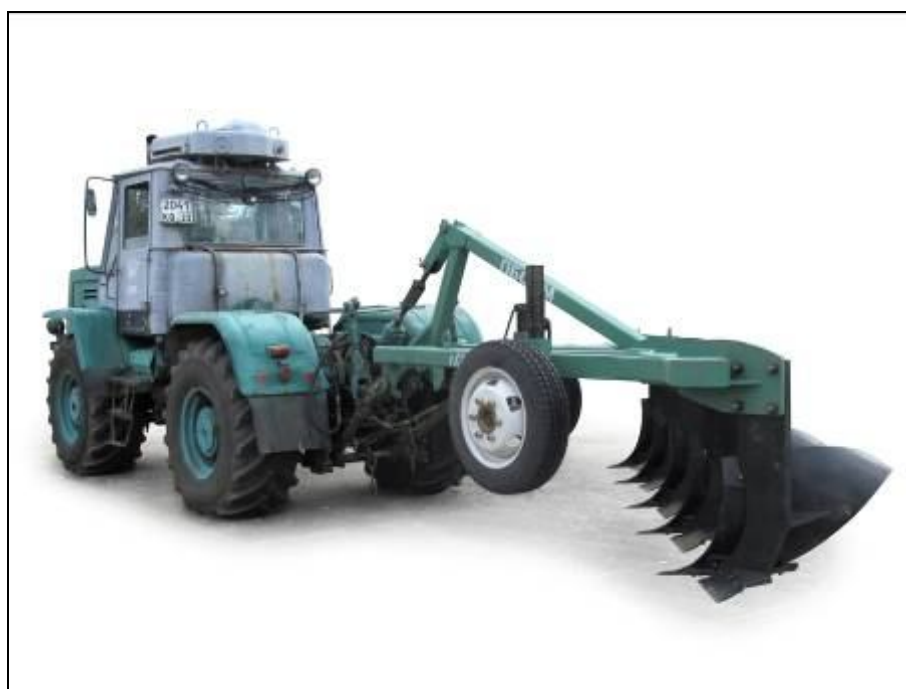
Рисунок 5 – ПБС-5М в агрегате с трактором Т-150К в транспортном положении, вид сзади слева
