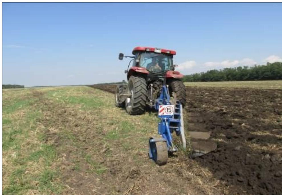
Рисунок 2 – Плуг ПНР-(4+1)х45П в агрегате с трактором CASE 210 на отвальной вспашке почвы
